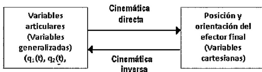
Figura 2.1: Los dos problemas fundamentales a resolver en la cinemática del robot.
